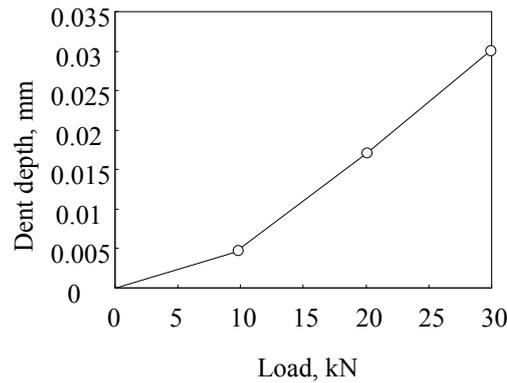
Fig. 12. Dent depth (pin-loading).
