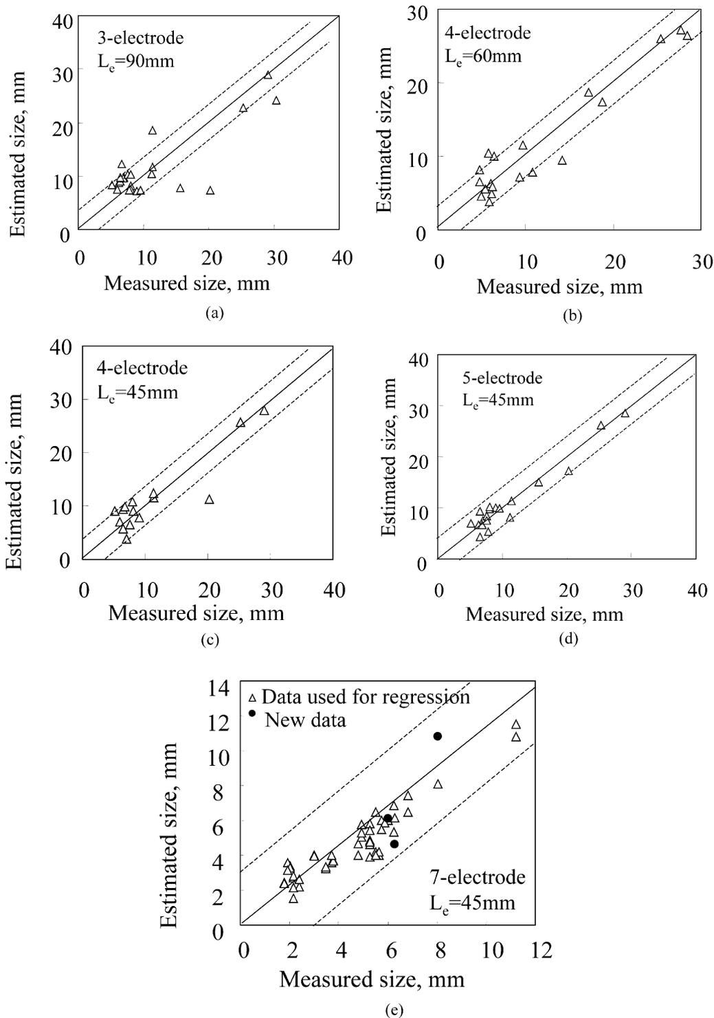
Fig. 14. Estimation of delamination sizes (length). (a) type A, (b) type B, (c) type C, (d) type D, (e) type E.
