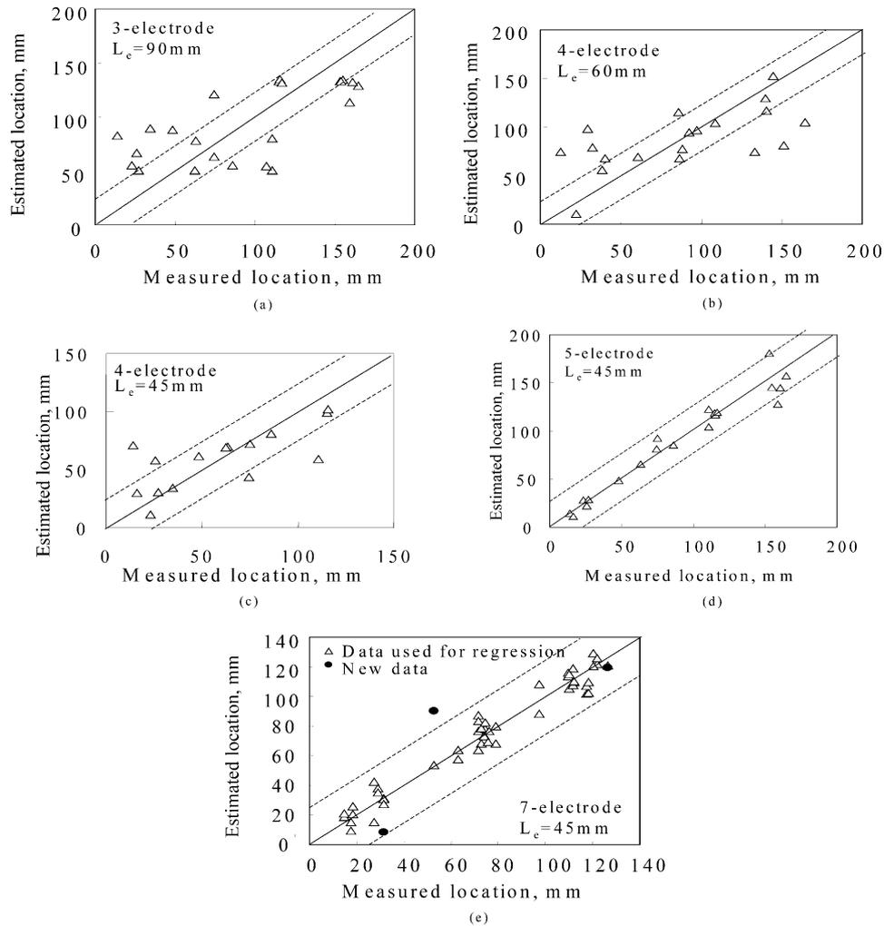
Fig. 12. Estimation of delamination locations. (a) type A, (b) type B, (c) type C, (d) type D, (e) Type E.
